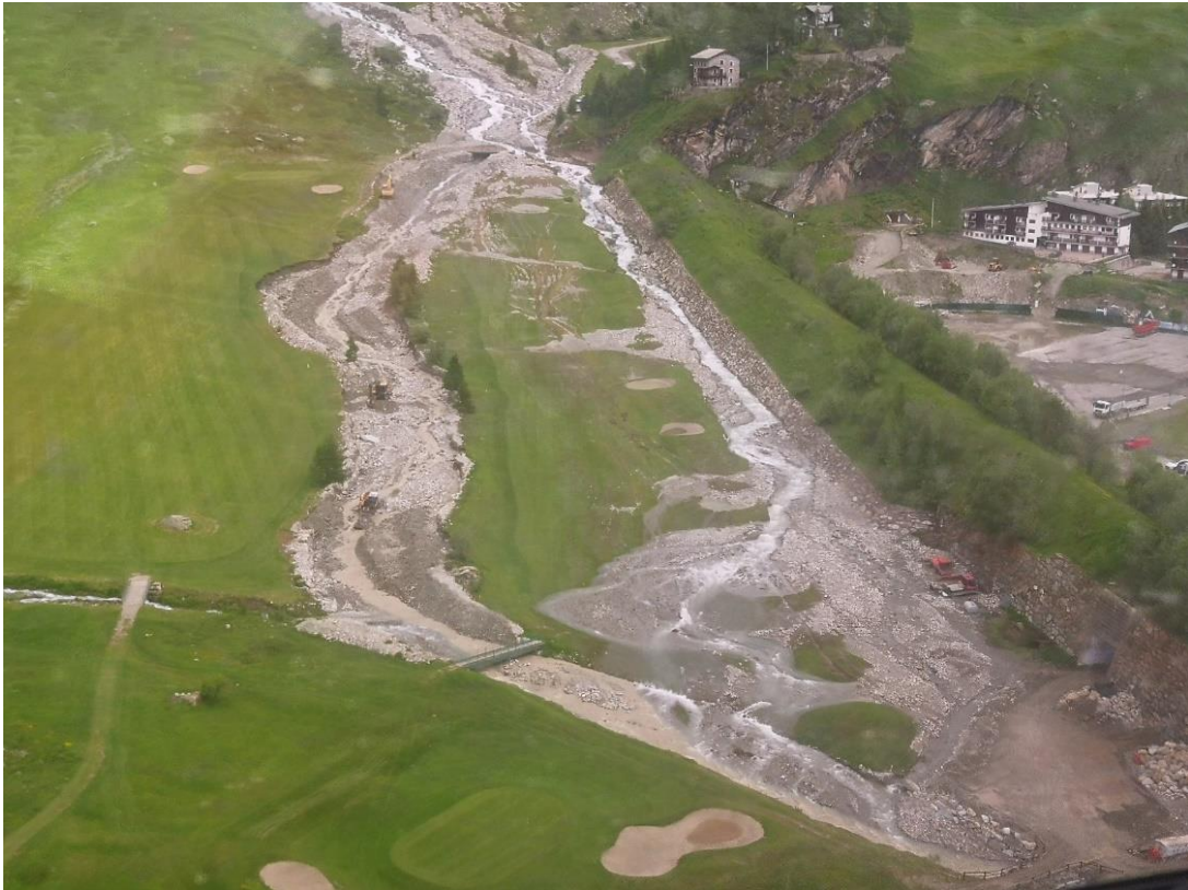
Esondazione del T. Cherillon dietro al vallo paravalanghe. Apertura di un nuovo alveo secondario (ID 3806).
