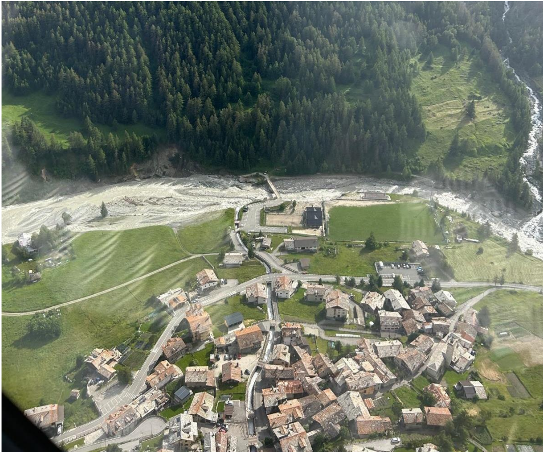
Vista da elicottero dell'abitato di Epinel con il tratto del T. Grand-Eyvia andato in erosione spondale ed esondazione (ID 3872)
