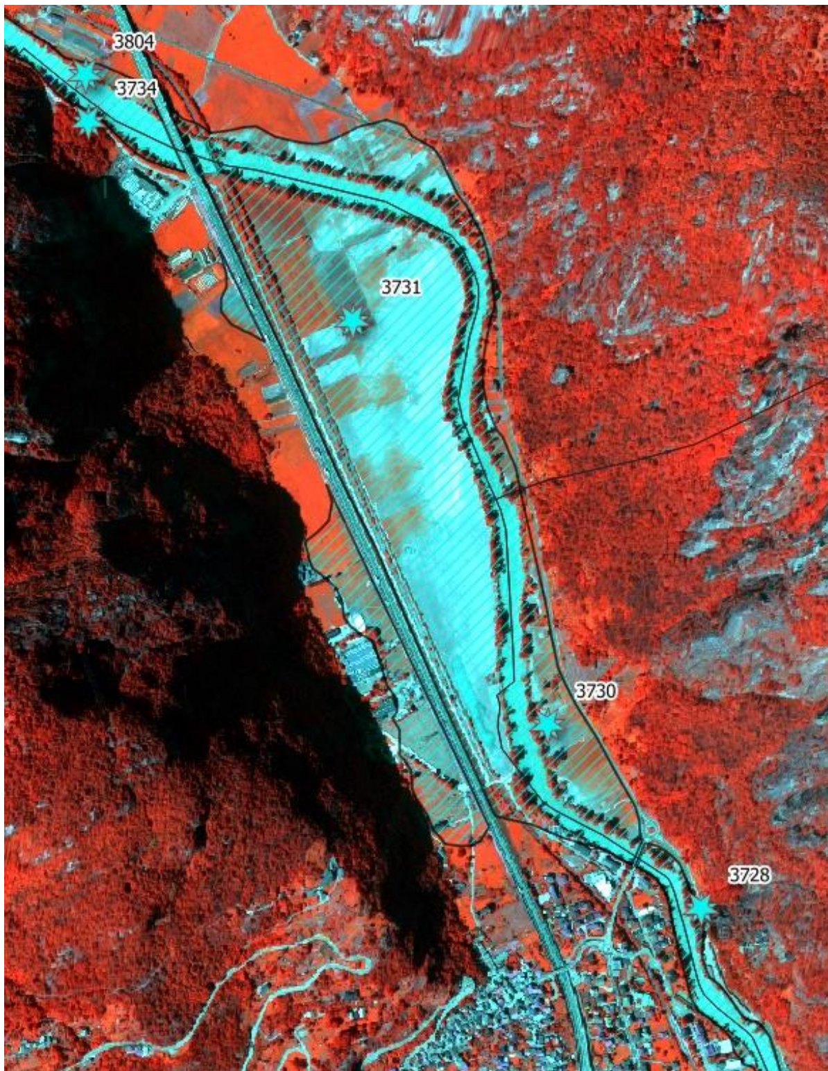
Immagine satellitare del 02 luglio – In falsi colori (NIR, GREEN, RED) per evidenziare (azzurro) le aree ancora occupate dall'acqua o dal fango. Perimetrazione delle aree alluvionate di Hône, Arnad e Bard- ID 3804-3747-3731-3730-3728. (Agg. 07-07-24).
